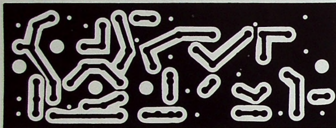
Bild 4 (oben). Platine des Senderteils (Maßstab 1:1)
